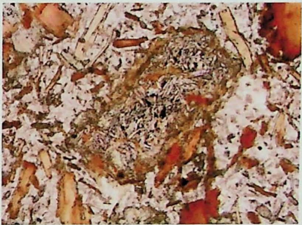
Fotomicrografia 4: Pseudomorfo de piroxênio substituído por tremolita e com a flogopita na borda (Lado maior:3,25mm; BTF-05, Botuverá).
