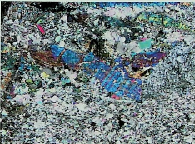
Fotomicrografia 9: Cristais de dipopsídio, com birrefribgência azulada, e em granulação bem maior do que os outros cristais (Lado maior: 3,25mm; BTF-13, Brusque).
